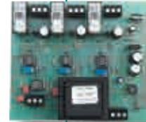
Steuermodul für Kaskadenschaltung von 2 Motoren Art. Nr. IS02
