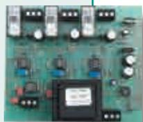
Steuermodul für Kaskadenschaltung von 3 Motoren
