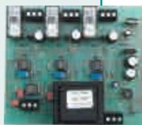
Steuermodul für Kaskadenschaltung von 2 Motoren
